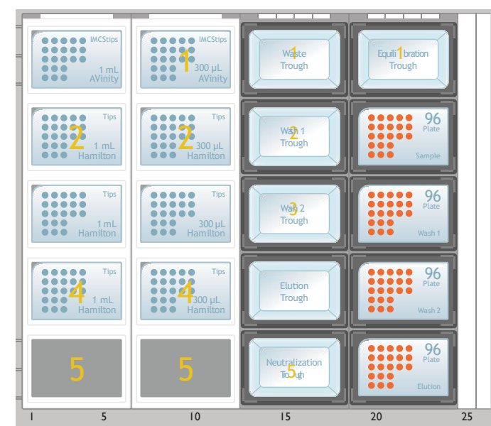
图1. 亲和纯化后进行缓冲液置换的典型台面布局
