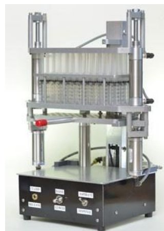
图 1. DPX 5 mL Pneumatic Extractor 是一种注射器装置，通过正负压来用 5 mL tips 吸打溶液
