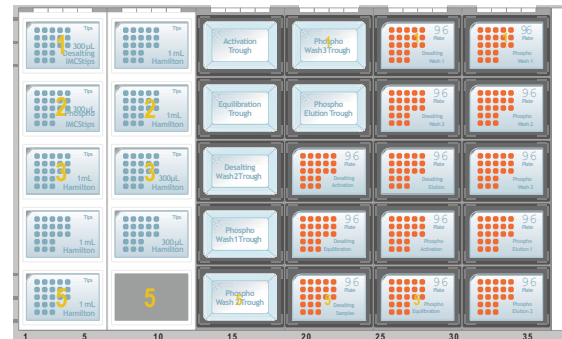
图5. 用于脱盐和磷酸肽富集自动化方法的 Microlab STAR 台面布局
