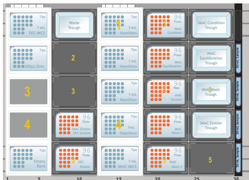
图1. 用于控制吸液和排液循环的图形用户界面，以及用于亲和纯化后缓冲液交换的典型台面布局。
