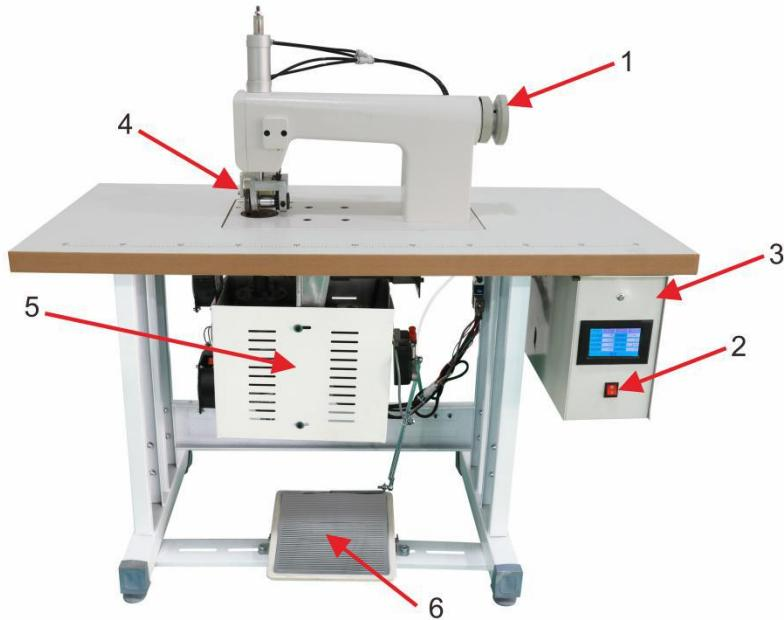
1. 机头                  2. 电源开关                  3. 电控箱
