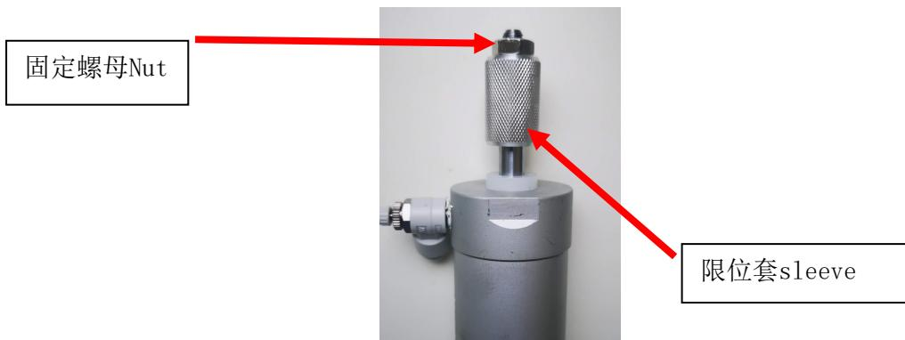
松开固定螺母，旋转限位套，调节气缸行程，改变花轮压痕深度。
